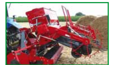
Ruota livellatrice "Flex" regolabile, indicata per controllare la profondità di semina.
